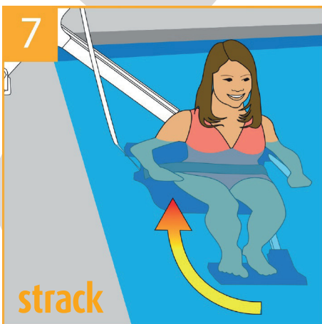
7 Um aus dem Wasser zu gelangen setzen Sie sich auf den Sitz und schliessen Sie den Gurt
